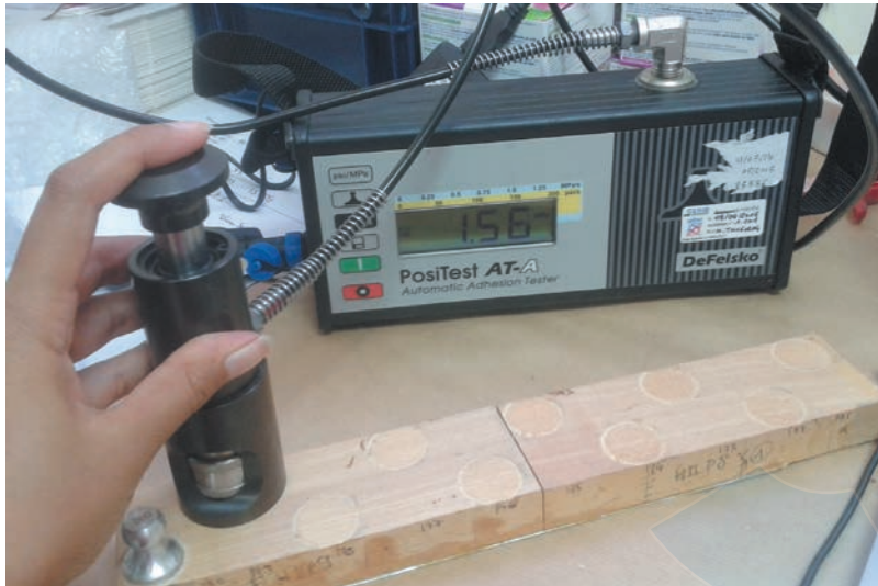
Résultats obtenus à l'issue des tests d'adhérence sur le hêtre et le chêne.
